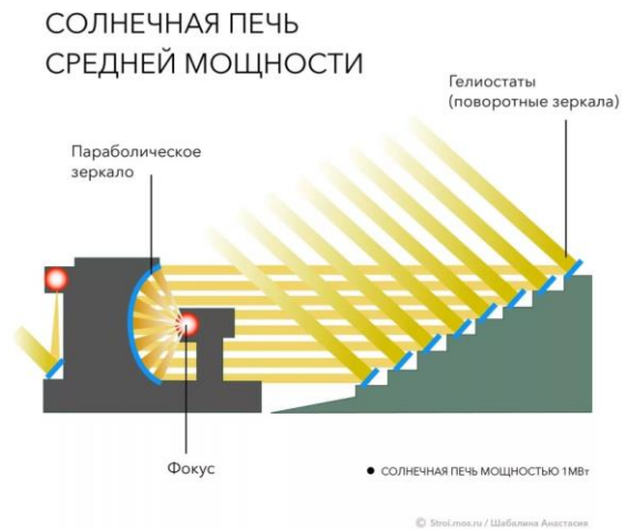
Рис. 6. Схема работы «солнечной печи».
